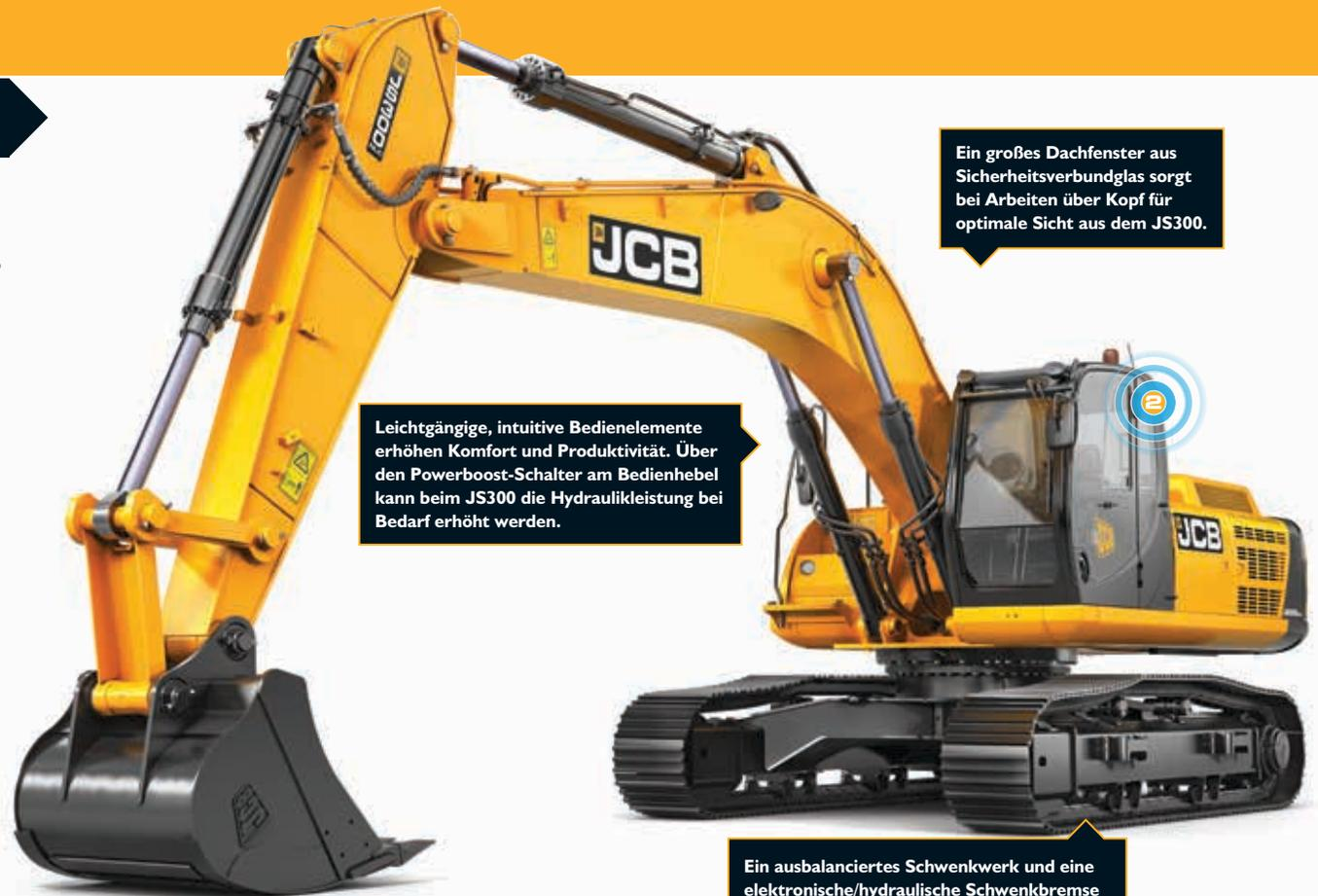
Ein großes Dachfenster aus Sicherheitsverbundglas sorgt bei Arbeiten über Kopf für optimale Sicht aus dem JS300.
