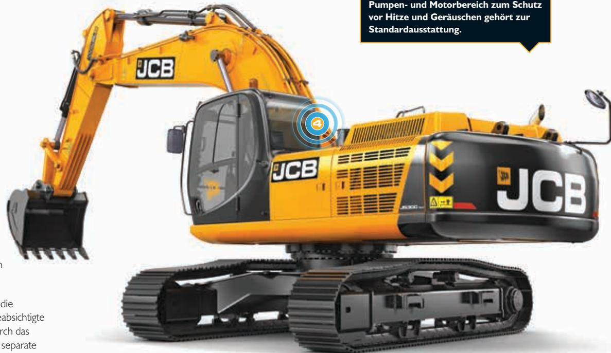
Ein isoliertes Schottblech zwischen dem Pumpen- und Motorbereich zum Schutz vor Hitze und Geräuschen gehört zur Standardausstattung.
