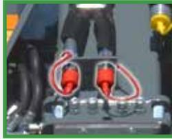
Doppeltwirkender Hydraulikkreis am Hebearm (mechanisch bedient)
