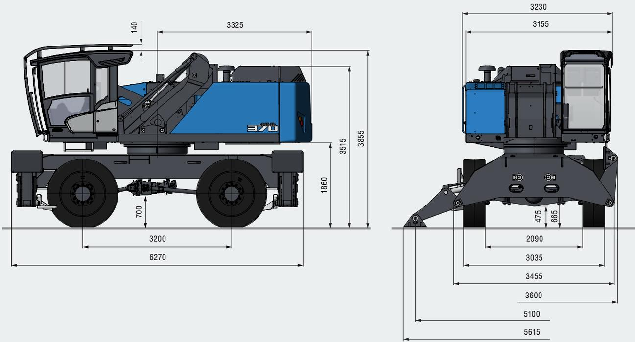
With vertically and horizontally adjustable cabin | Mit hoch- und vordfahrbarer Kabine | Avec cabine à élévation et à avancement
